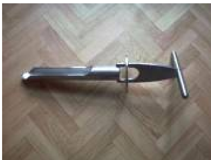
Рис. 3. Пробоотборник для взятия проб стволовой части мозга КРС производства фирмы «IZTL» [7]
