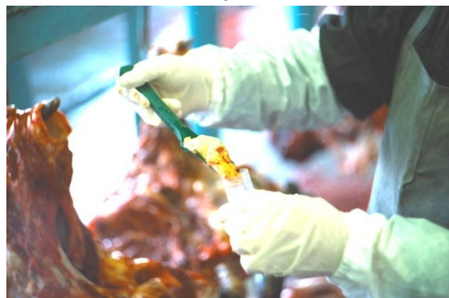
Рис. 4. Отбор проб мозга пластиковым пробоотборником фирмы «Bio-Rad» (фото 1–8)
